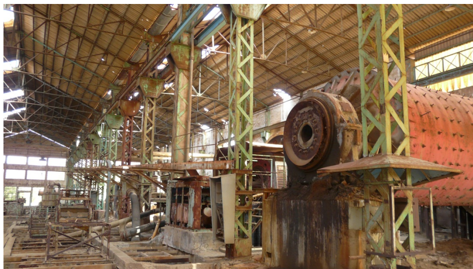
31, 32, 33 y 34. Estado actual del interior de la gran nave de molienda y flotación del lavadero Roberto.
