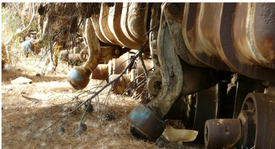
16. Detalle de los dispositivos de vuelco de las vagonetas.
