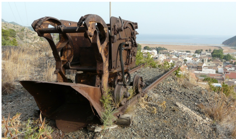
24, 25, 26 y 27. Detalles del estado actual de la original pala cargadora neumática localizada en el trazado de la antigua vía férrea junto al túnel José Maestre.
