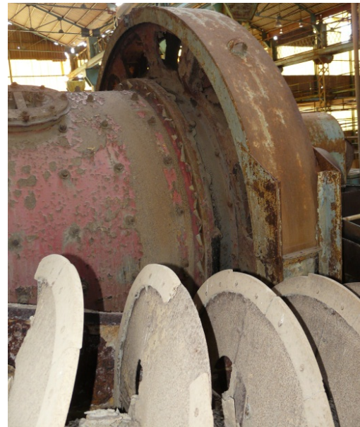
40. Estado actual del molino de barras.
