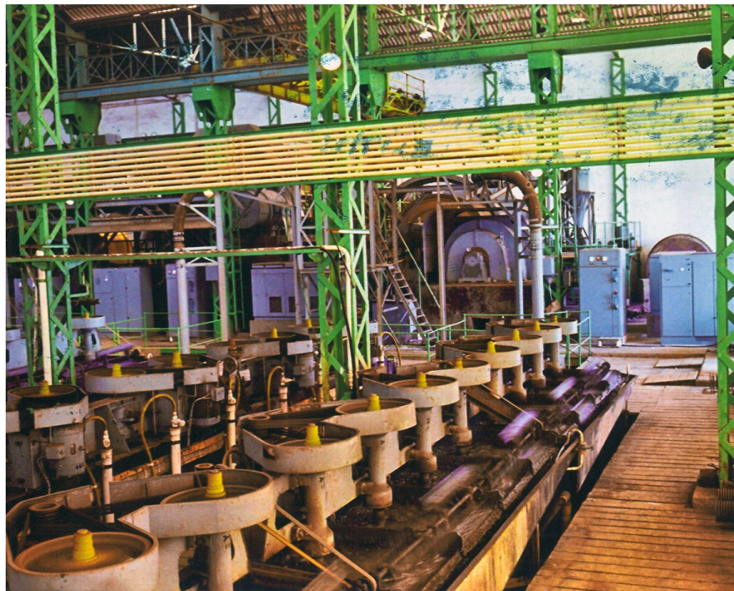
63 y 64. Imágenes de las celdas de flotación del Lavadero Roberto en 1985 y 1986
