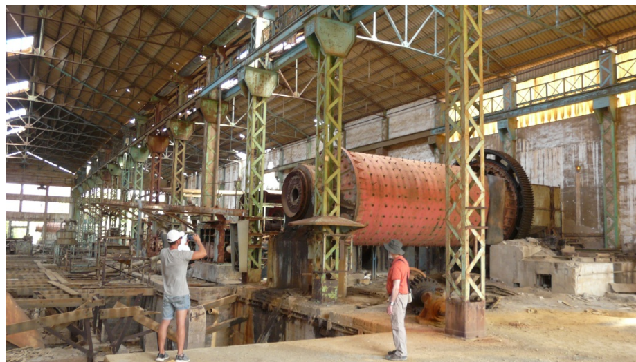
40. Estado actual del molino de barras.
