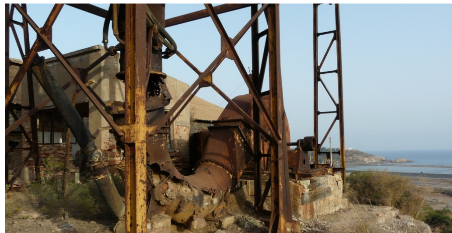
23 y 24. Conducciones y tuberías de aspiración y conducción del polvo hasta las torres de evacuación en forma de chimenea. En algunas de estas estructuras metálicas se aprecia un grado de corrosión muy intenso.
