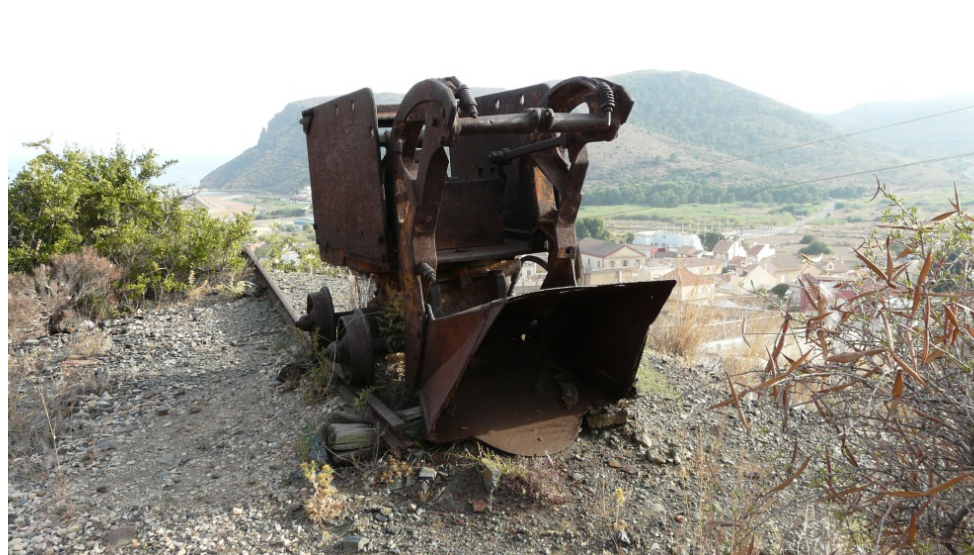
24, 25, 26 y 27. Detalles del estado actual de la original pala cargadora neumática localizada en el trazado de la antigua vía férrea junto al túnel José Maestre.
