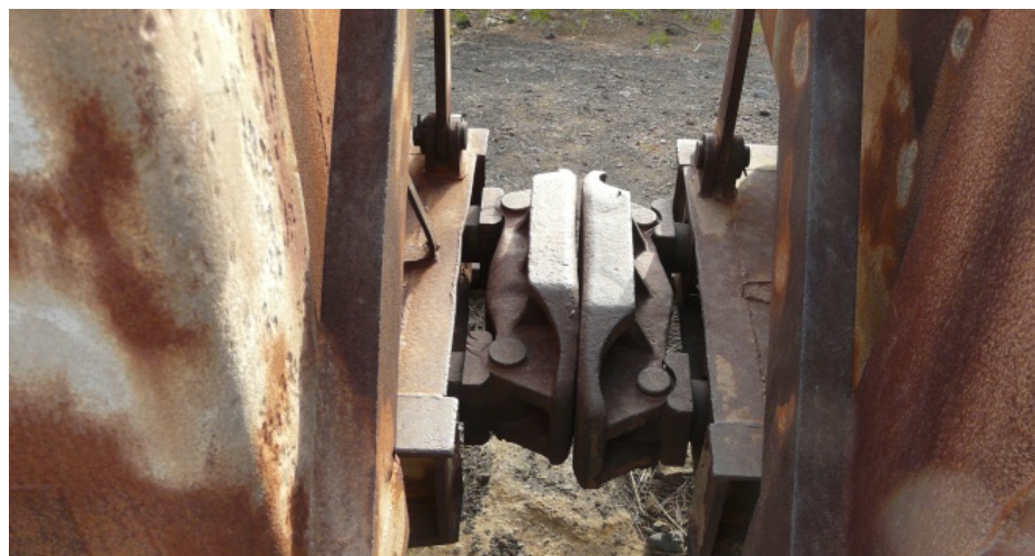
17. Detalle del mecanismo o sistema de unión entre las vagonetas.
