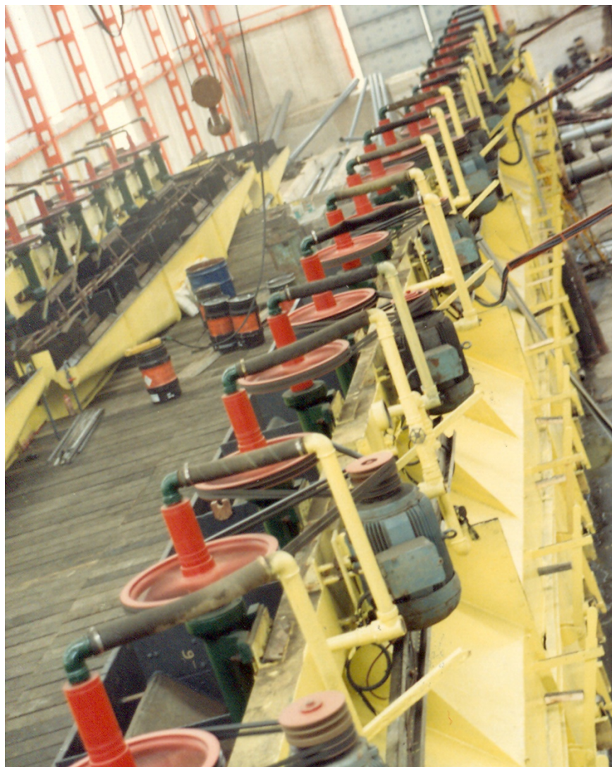
63 y 64. Imágenes de las celdas de flotación del Lavadero Roberto en 1985 y 1986
