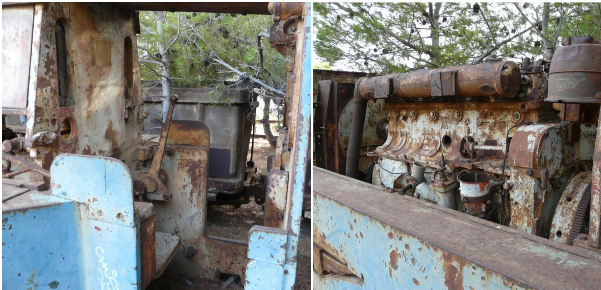
22 y 23. Detalle del estado actual de las locomotoras existentes en las proximidades del túnel José Maestre.
