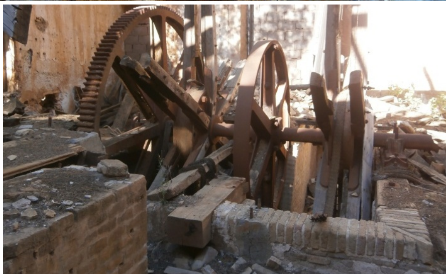
22, 23, 24 y 25. Estado actual de la maquinaria de tracción que alberga la casa de máquinas de la mina Santo Tomás.
