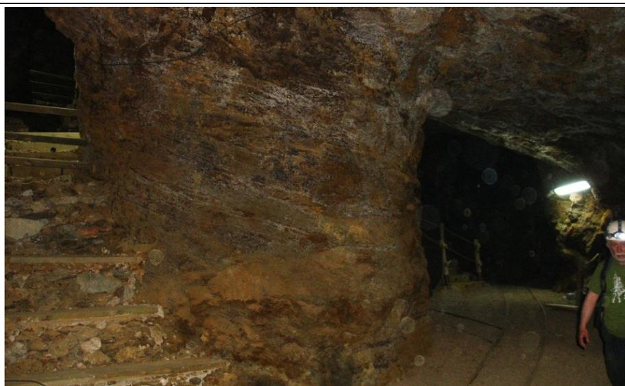
12. Pilar mostrando la estructura bandeada del manto mineral.
