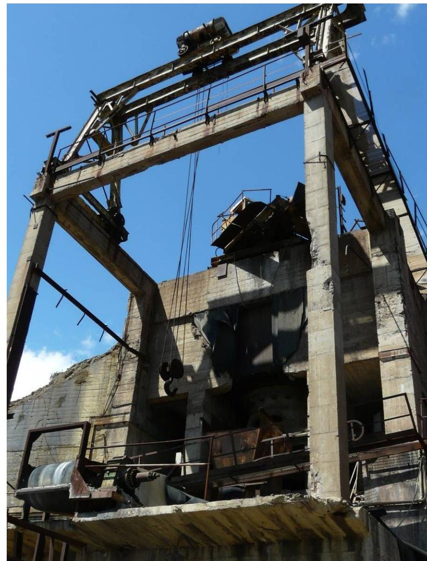
11, 12 y 13. Vistas del puente grúa que se utilizaba para eliminar atranques de bloques en la machacadora.
