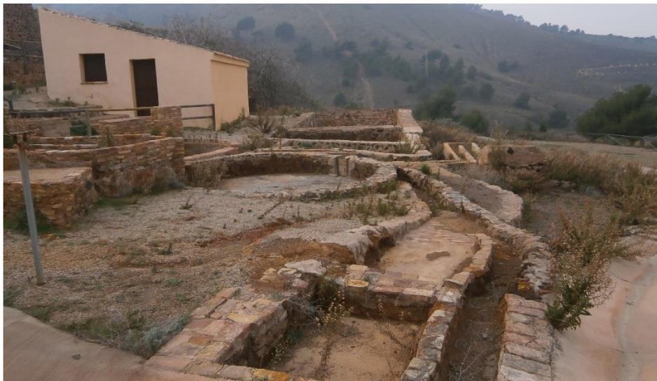
18. Terraza inferior del lavadero de la mina Remunerada con el basamento de un palanquín y el canal de apure para el mineral.
