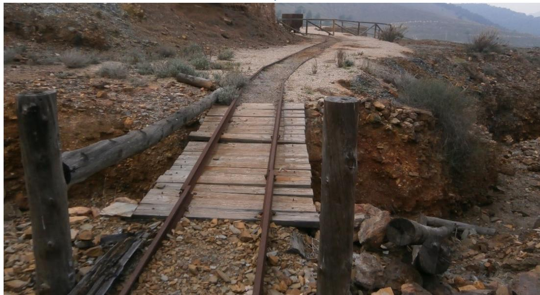
5, 6 y 7. Sistema de railes para el transporte del mineral con vagonetas hasta el lavadero.
