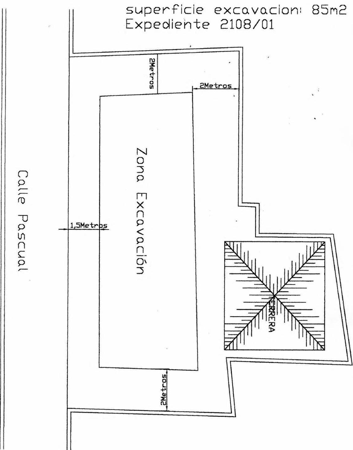
Figura 2. Croquis del solar y zona de excavación.
