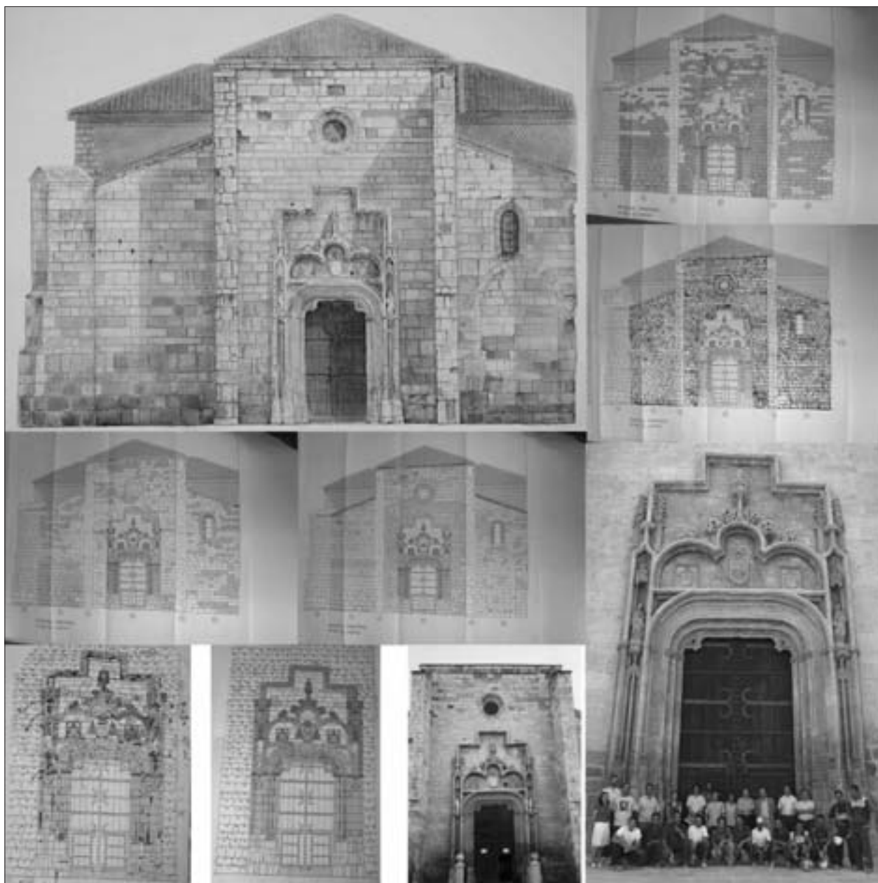
Diversas imágenes del Plan Director de la Catedral Magistral de Los Santos Niños en Alcalá de Henares. El dibujo (arriba izda.) corresponde con el estado previo de la fachada principal con indicación de color y patologías. Los planos señalan los distintos deterioros de la piedra. Las cuatro imágenes inferiores corresponden a los deterioros de la portada, y señalan los deterioros y zonas de actuación, el estado previo y el final, con todos los profesionales intervinientes en la misma.
