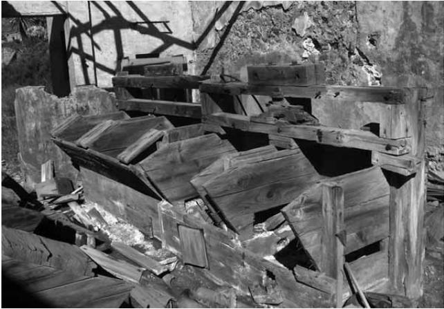
Lámina 11. Celdas del lavadero de flotación situado en la mina Demasía a Buena Suerte (Rambla del Abenque).
