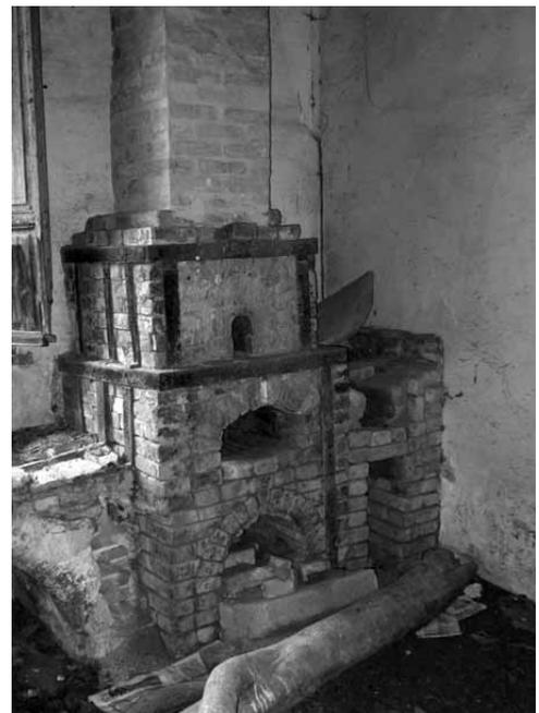
Lámina 15. Horno de laboratorio en el interior de las instalaciones de la mina El Cielo (El Descargador).
