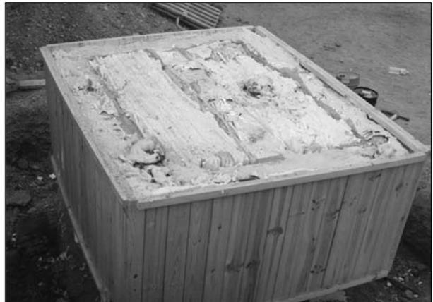
Lámina 15.1. Vista con el cajón de madera y el poliuretano empezando a expandir.
